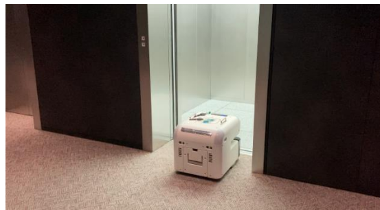
エレベーターへの自動乗り入れ風景
